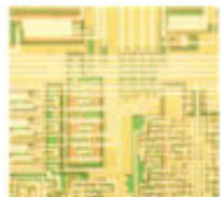
De door Fluke ontworpen en gefabriceerde Measure ment Acquisition Chip (MAC) vormt het hart van de 8060A. De MAC is meer dan een simpele A/D-omzetter en biedt allerlei extra mogelijkheden.
