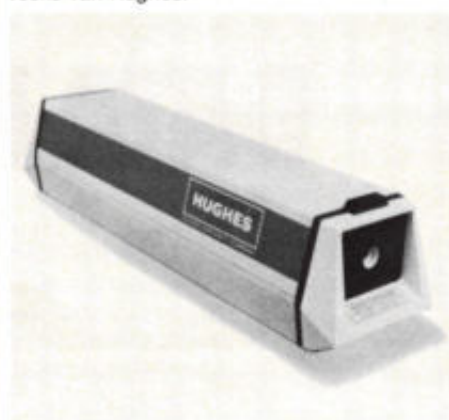
Afb. 7. Universele HeNe-laser uit de 3300-reeks van Hughes.
